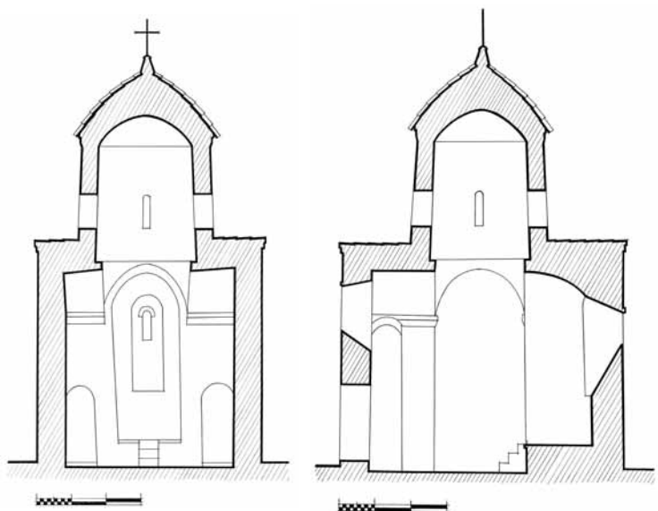
ԴԱԴԻ ՎԱՆՔ. գմբեթավոր փոքր եկեղեցու հատակագիծը և վերականգնման նախագծերը. արևմտյան և հարավային ճակատներ, կտրվածքներ դեպի արևելք և հյուսիս (հեղ.՝ Ս. Այվազյան, 1997 թ.)
